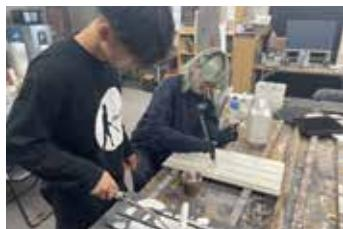
設計士や建設会社の思い描いている外壁が仕上がるよう、塗料の配合や施工方法を変えてサンプルを作っています。求められているサンプルを作り、建物がサンプル通りの外壁で出来上がるとすごく感動します。
